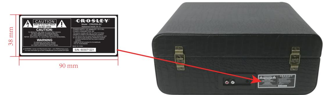
尺寸:90x38mm 材质:背3M加强胶、黑底白字、表面过光胶。 测试:防水、过酒精、过3M胶、过高温、RoHS。 注:粘性要强,避免贴后出现脱落。 贴在机子后板旁边
