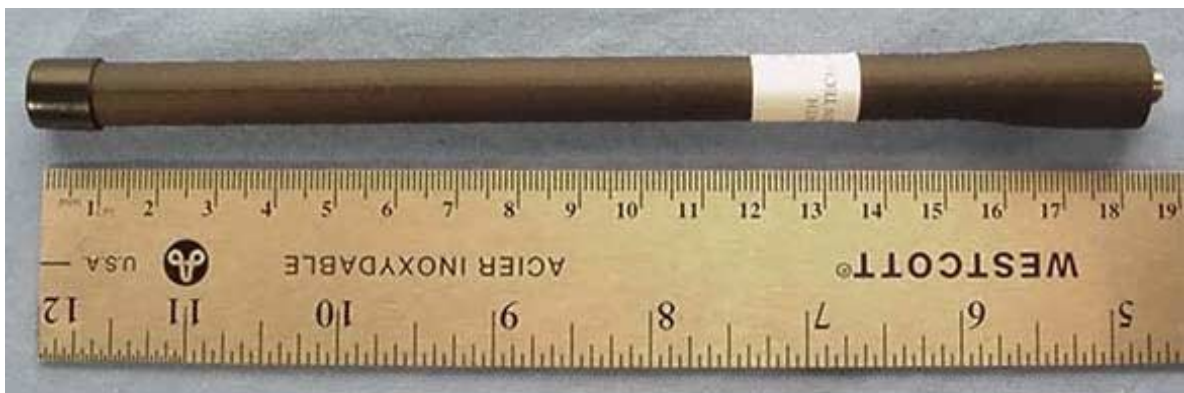
Antenna P/N: 501-0017-103 (151-162 MHz)
