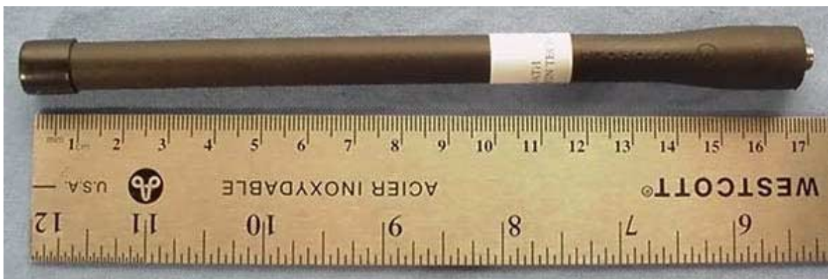
Antenna P/N: 501-0017-105 (162-174 MHz)
