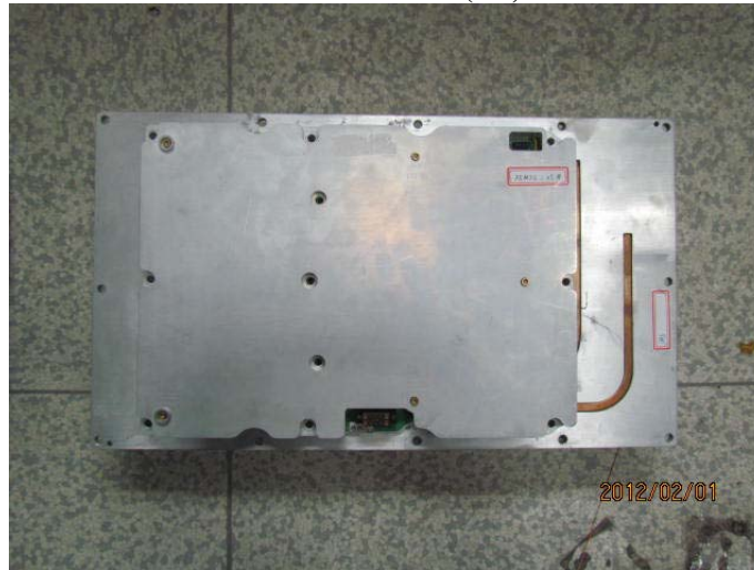
POWER AMPLIFIER (PA) - BOTTOM
