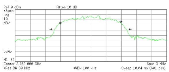
Occupied Bandwidth 1.1894 MHz Осс ВW % Рыг 99.00 % х dB -26.00 dB
