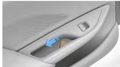
Lorsque le sélecteur de vitesses est en position P (Stationnement), tirez une fois sur la poignée de déverrouillage (mise en surbrillance) pour déverrouiller et ouvrir la porte. Notez que ce mécanisme de déverrouillage électronique est désactivé lorsque le véhicule est en mouvement.
