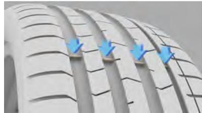
Les pneus d'origine sont munis d'indicateurs d'usure moulés dans la sculpture de la bande de roulement.
