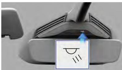
Pour allumer ou éteindre l'éclairage intérieur avant, utilisez l'interrupteur situé sur la console supérieure ou touchez chaque lampe individuellement.
