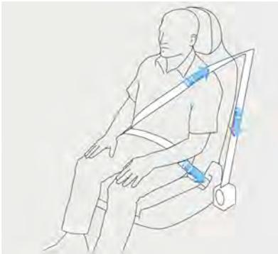
Les prétendeurs rétractent automatiquement les ceintures de sécurité, ce qui réduit le mou dans les ceintures sous-abdominale et épaulière, et ce qui réduit ainsi le mouvement vers l'avant de l'utilisateur de la ceinture de sécurité.
