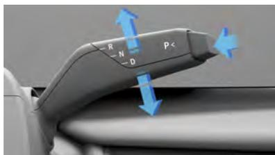
Lorsque le véhicule est à P (Stationnement) ou N (Point mort), déplacez le levier situé du côté droit de la colonne de direction vers le haut ou vers le bas pour sélectionner la marche arrière ou la marche avant. Le panneau central de l'écran tactile affiche la sélection actuelle. Lorsque le véhicule est en position P (Stationnement), vous devez aussi appuyer sur la pédale de frein avant de sélectionner D (Marche avant) ou R (Marche arrière).
