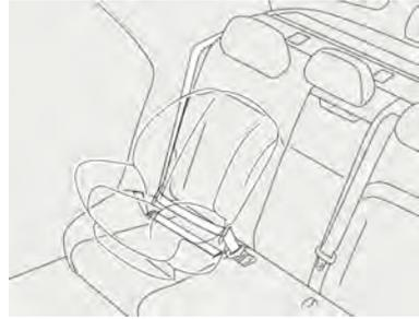
1. Placez le siège de sécurité pour enfants dans le siège du véhicule et sortez complètement la ceinture de sécurité pour engager le rétracteur à blocage automatique. Voir [Enrouleur à blocage automatique](#). Acheminez la ceinture de sécurité pour fixer en place le siège pour enfants et fixez-la en place conformément aux instructions du fabricant.
