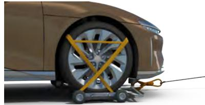
Assurez-vous de bien attacher le véhicule au plateau conformément aux instructions du fabricant du chariot, le véhicule devant rester sur les chariots.
