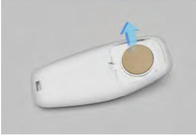
3. Évitez de toucher les surfaces plates de la pile neuve si possible, car les traces de doigts peuvent réduire la durée de vie de la pile.
