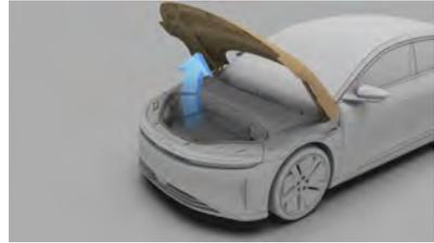
*Remarque* : Par temps extrêmement froid, il se peut que les vérins à gaz ne maintiennent pas le capot aussi fermement qu'ils le font par temps plus chaud.
