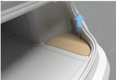
Une prise d'alimentation 12 V est située dans le coffre arrière. Retirez le panneau de plancher de droite pour accéder à la prise d'alimentation.
