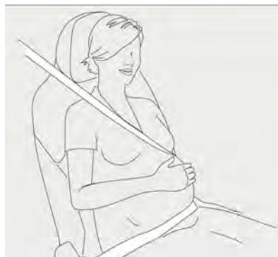
La ceinture sous-abdominale doit être portée le plus bas possible au niveau des hanches, et non au niveau de la taille. Positionnez la ceinture épaulière entre les seins et sur le côté de l'abdomen. Assurez-vous que la ceinture de sécurité n'est pas lâche et qu'elle n'est pas tordue.
