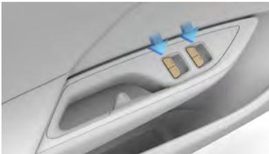
Les commandes de vitre de la porte du conducteur commandent toutes les vitres du véhicule. Tirez la commande vers le haut ou
