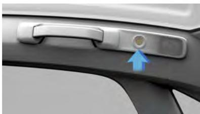
Pour allumer ou éteindre l'une des deux lampes de lecture du passager arrière, appuyez sur la partie centrale de la lentille de la lampe.
