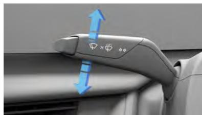
Déplacez le levier situé sur la gauche de la colonne de direction vers le bas pour actionner les clignotants de gauche ou vers le haut pour actionner les clignotants de droite. Les clignotants continuent de fonctionner jusqu'à ce qu'ils soient automatiquement désactivés lorsque vous tournez le volant ou que vous poussez légèrement le levier de la colonne de direction dans le sens opposé.
