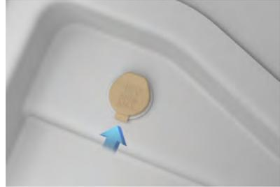
Bien que la prise d'alimentation soit principalement destinée à l'utilisation de la trousse de réparation de pneu, elle peut aussi être utilisée pour d'autres accessoires qui consomment jusqu'à 15 A ou un maximum de 180 watts.
