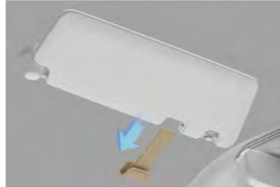
Lorsque le pare-soleil est en position repliée, faites glisser le porte-piles vers l'avant du véhicule.
