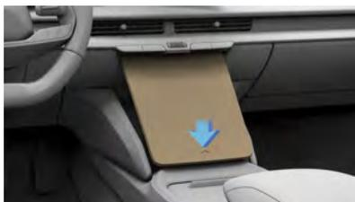
Appuyez sur la flèche à la base du panneau pilote et maintenez-la enfoncée. Le panneau se rétracte dans le tableau de bord, exposant ainsi l'espace de rangement derrière lui. Appuyez de nouveau sur la flèche pour déployer le panneau pilote.
