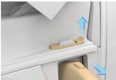
3. Assurez-vous de remettre correctement le levier de débranchement manuel à sa position d'origine avant de fermer le capot.
