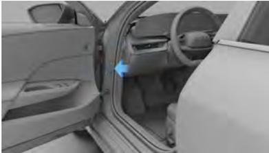
Consultez l'étiquette de certification du véhicule située sur le montant de portière avant côté conducteur, près de la roue avant, pour connaître la charge maximale de votre véhicule selon le poids nominal brut du véhicule.
