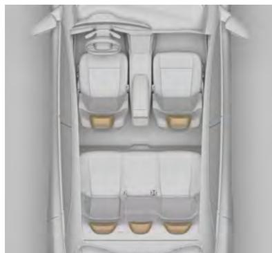
Le véhicule est équipé d'un appuie-tête réglable à chaque position, à l'exception du siège central arrière.
