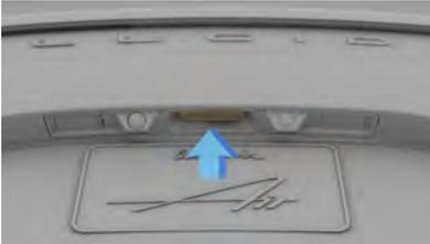
2. Ouvrez le coffre arrière et retirez l'œillet de remorquage sous le panneau de plancher du coffre, du côté droit.
