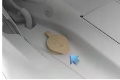
1. Nettoyez le bouchon de remplissage avant de l'ouvrir pour empêcher la saleté de pénétrer dans le réservoir.
