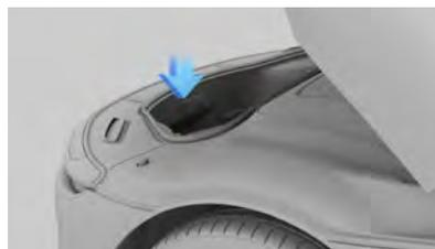
Si une personne est coincée dans le coffre avant, vous pouvez ouvrir le capot de l'intérieur en appuyant sur le bouton d'ouverture intérieur.
