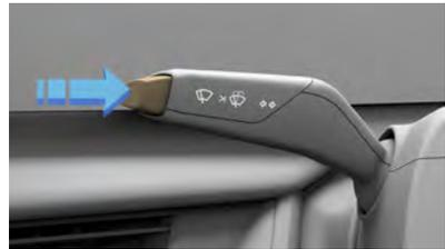
Le bouton de la manette sur la colonne de direction gauche sert aux commandes d'essuie-glace. Pour obtenir un seul balayage à sec, appuyez une fois sur le bouton jusqu'au premier cran. Appuyez et maintenez le bouton enfoncé au premier cran pour plusieurs balayages à sec. Pour un jet de lave-glace, appuyez sur le bouton jusqu'au deuxième cran. Maintenez le bouton enfoncé au deuxième cran pour plusieurs cycles de lavage avec jet de lave-glace.
