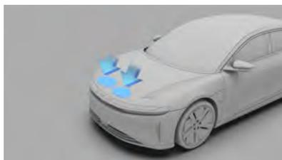
4. Après la fermeture, vérifiez que le verrou est bien engagé en essayant de soulever le rebord avant du capot. Le capot ne doit pas bouger.
