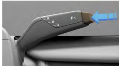
Le frein de stationnement est appliqué automatiquement lorsque la position de stationnement (P) est sélectionnée et se desserre chaque fois qu'un rapport est sélectionné. Il est également engagé par certains systèmes lorsqu'un délai est atteint. Voir [Maintien des freins](#) à la page 91.
