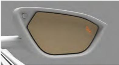
Lorsqu'un objet est détecté dans un angle mort, le voyant à DEL ambré dans le rétroviseur de ce côté s'allume.
