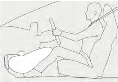
Les coussins gonflables pour genoux fonctionnent de concert avec le déploiement des coussins gonflables avant. Lorsqu'ils se déploient, les coussins gonflables pour genoux limitent le mouvement vers l'avant du conducteur ou du passager avant en retenant les jambes, ce qui permet de positionner l'occupant de façon à ce que les coussins gonflables avant fonctionnent plus efficacement.
