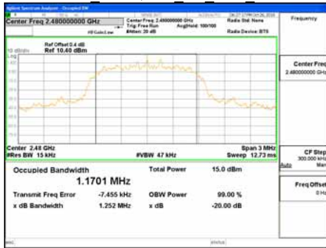
OBW 20dB π4DQPSK 2M DH5 2480MHz
