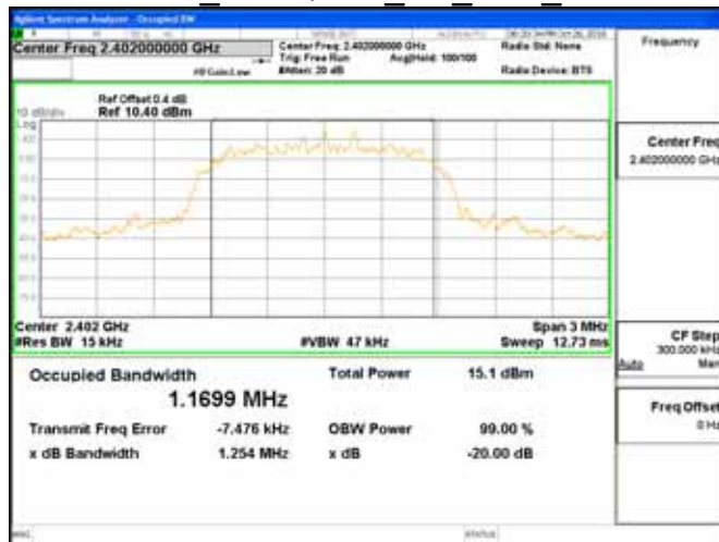
OBW 20dB π4DQPSK 2M DH5 2441MHz
