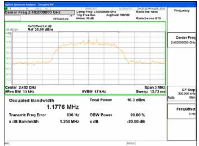
OBW 20dB π4DQPSK 2M DH5 2441MHz
