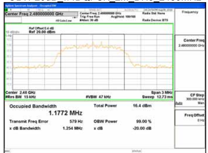
OBW 20dB π4DQPSK 2M DH5 2480MHz
