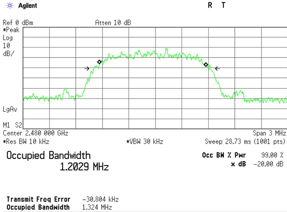
3) Packet Setting : 3 DH5 (Modulation type : 8DPSK)
