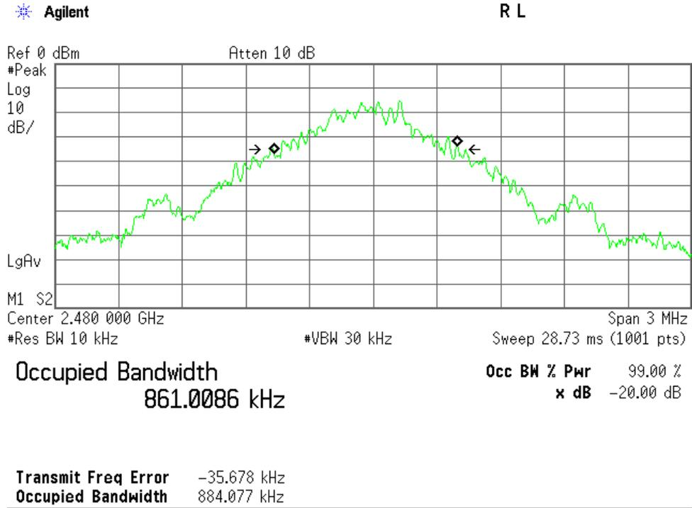
2)Packet Setting : 2DH5(Modulation type : pi/4-DQPSK)
