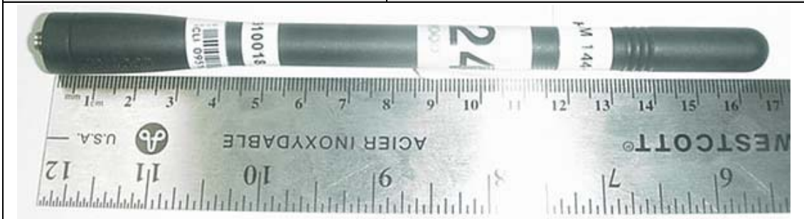
Whip Antenna P/N: KRA-26M
