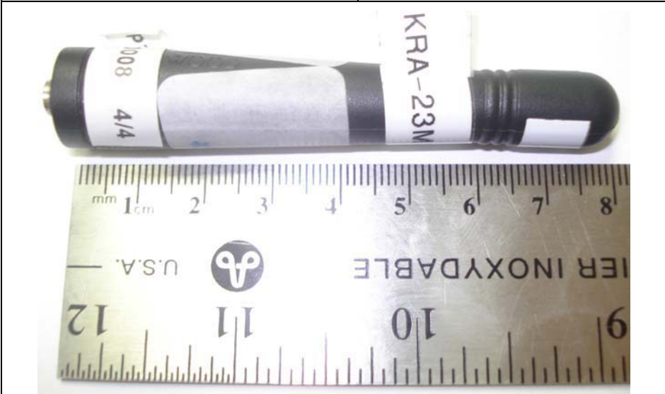
Stub Antenna P/N: KRA-23M3
