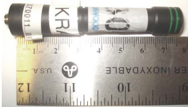
Antenna P/N: KRA-17M2 (Antenna B) - Length = 74 mm
