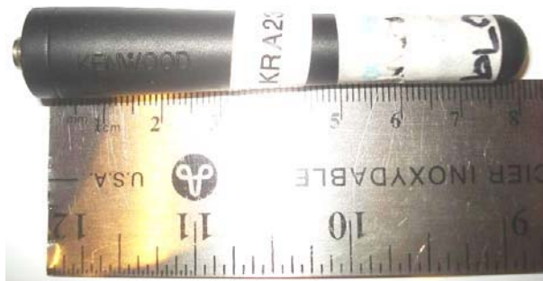
Antenna P/N: KRA-23M (Antenna C) - Length = 80 mm
