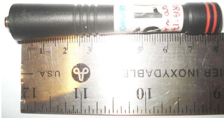
Antenna P/N: KRA-17M (Antenna A) - Length = 79 mm
