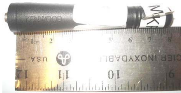
Antenna P/N: KRA-23M2 (Antenna D) - Length = 80 mm
