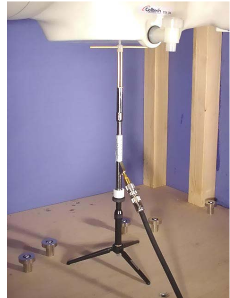
900MHz Dipole Setup
