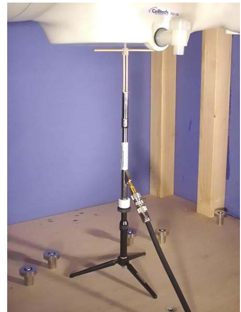
900MHz Dipole Setup
