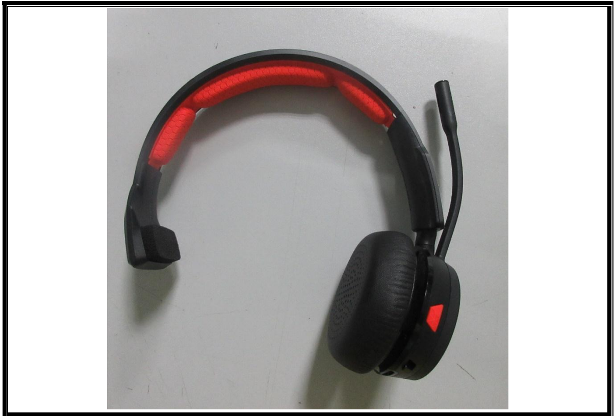
整体照 物理尺寸：长 X 宽 X 高=179.89mm(L) X 155.21mm(W) X 67.86mm(H)
