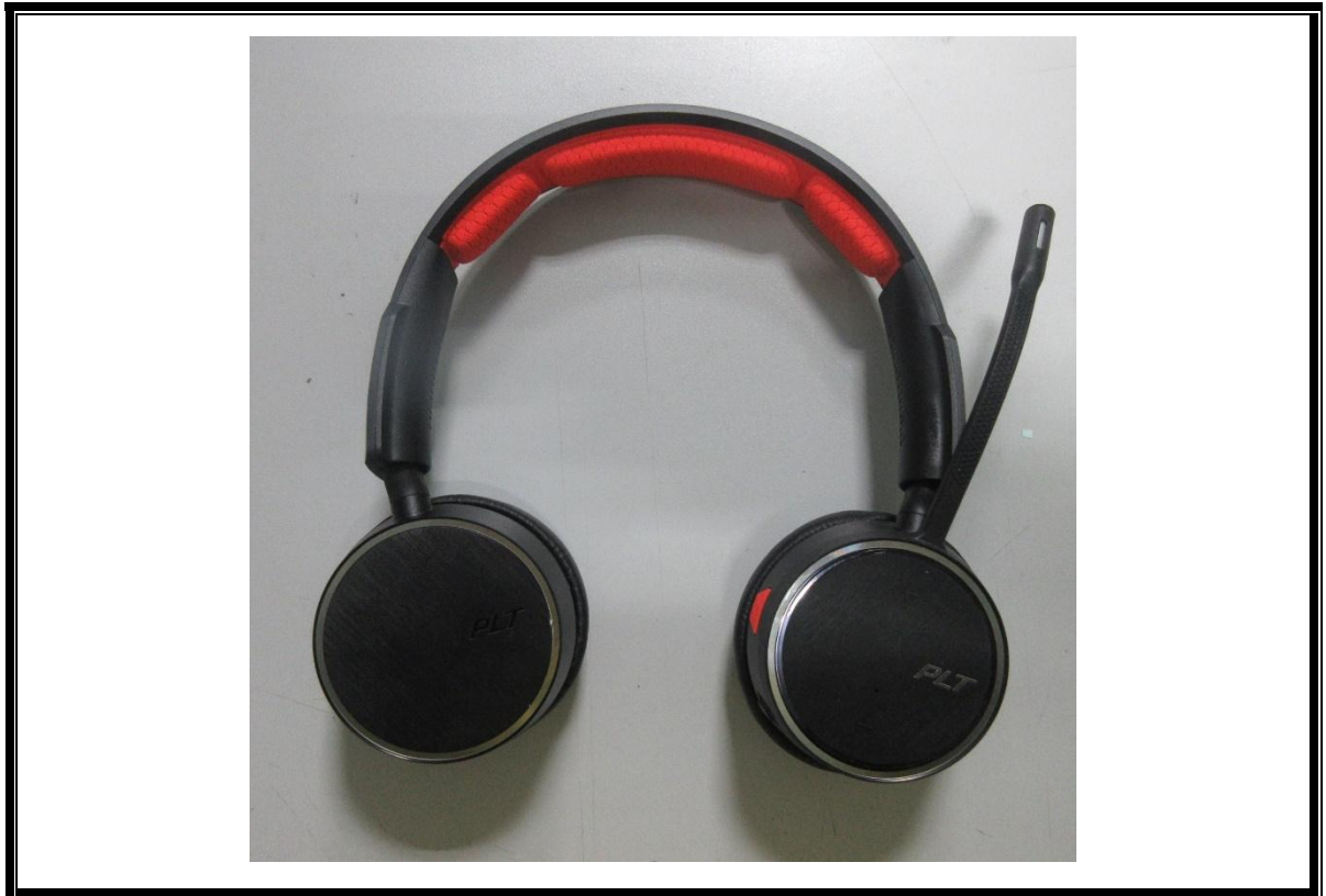
整体照 物理尺寸：长 X 宽 X 高=179.89mm(L) X 155.21mm(W) X 67.68mm(H)
