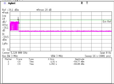
Marker 1 : End of Burst : 1310 ms Marker 2 : End of Transmission : 1392 ms
