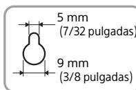
Orificio en la parte trasera de la barra parlante
