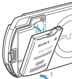
Alignez les pattes du couvercle de la batterie sur le système jusqu'à ce qu'il s'enclenche.
