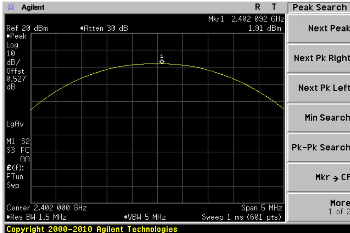
Peak Power Output Data Plot (CH Mid) (EDR mode) ( $\pi/4$ DQPSK)
