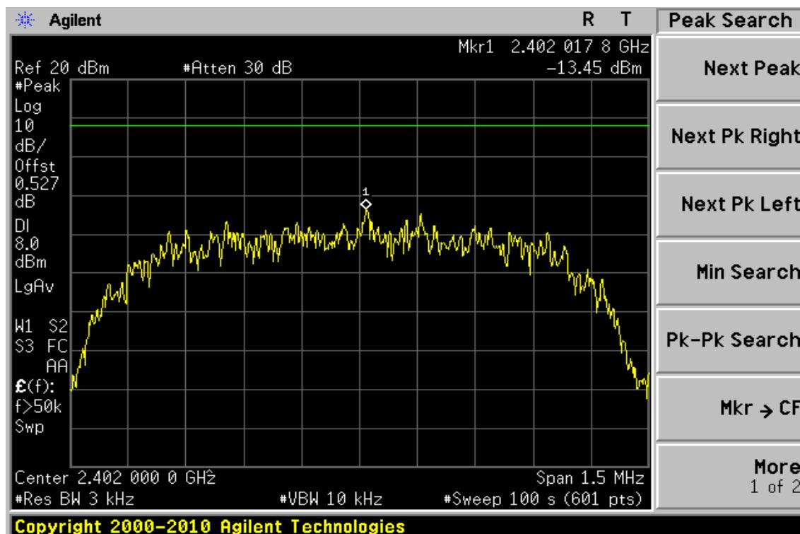
Power Spectral Density Test Plot (CH-Mid) (EDR) ( $\pi/4$ DQPSK)
