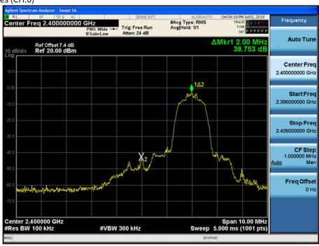
Test Plots without hopping ( $\pi/4DQPSK$ )
