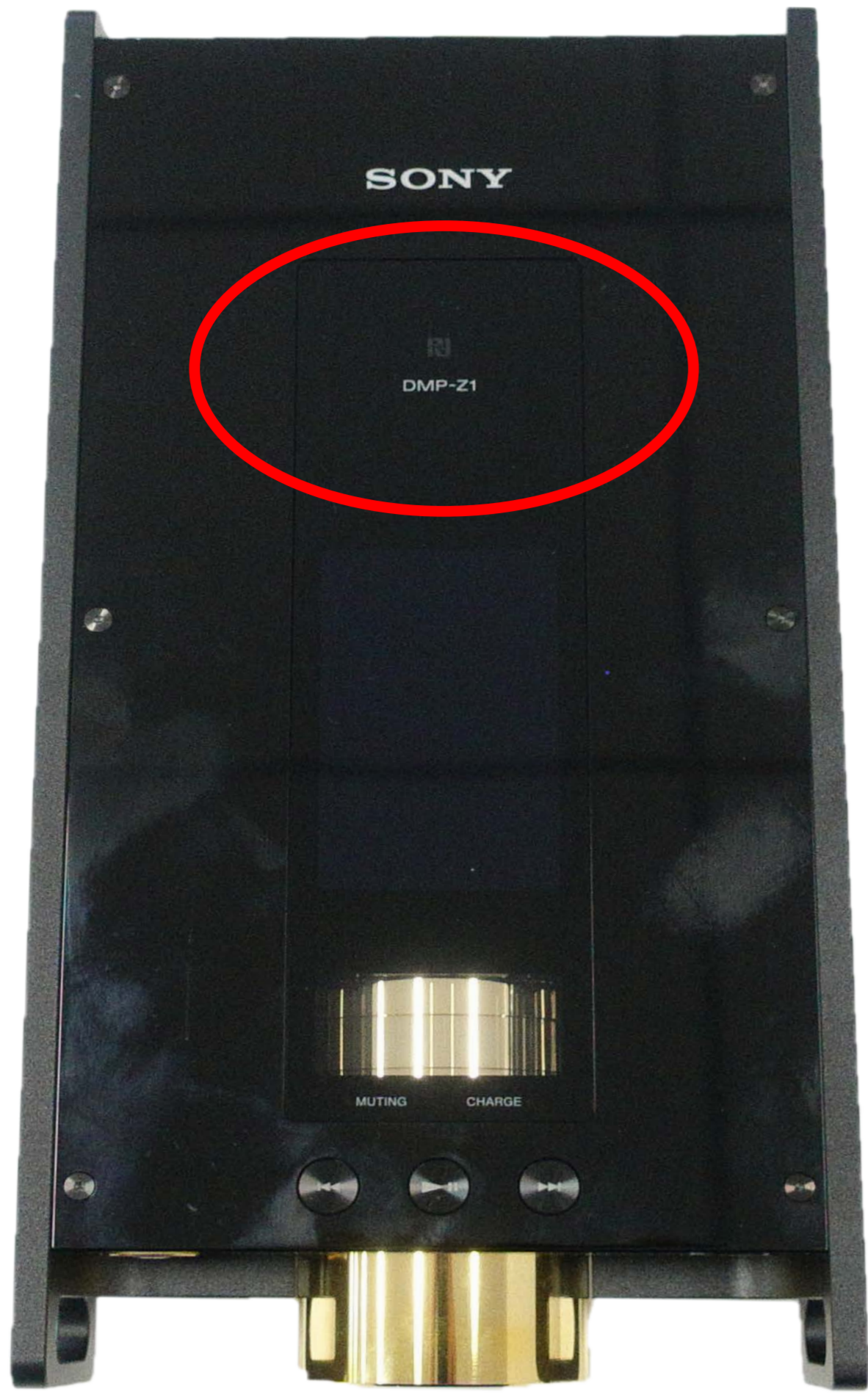
DMP-Z1 NFC Antenna Position
