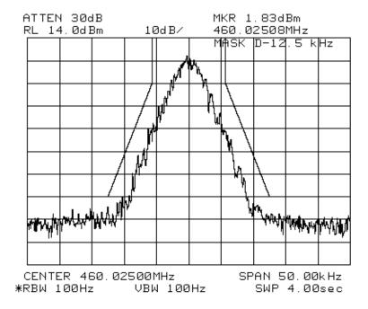
TYPE OF EXHIBIT: OCCUPIED BANDWIDTH-6.25 kHz CHANNELS
