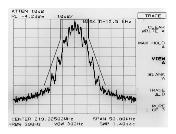
TYPE OF EXHIBIT: OCCUPIED BANDWIDTH-6.25 kHz CHANNELS
