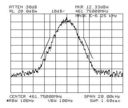
TYPE OF EXHIBIT: OCCUPIED BANDWIDTH-6.25 kHz CHANNELS
