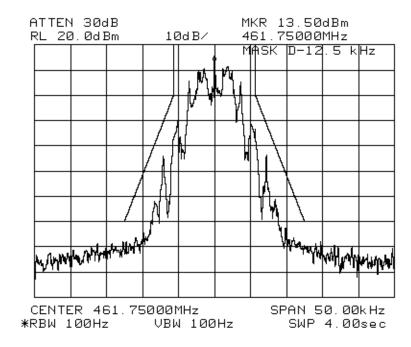
TYPE OF EXHIBIT: OCCUPIED BANDWIDTH-6.25 kHz CHANNELS
