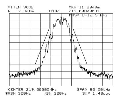
TYPE OF EXHIBIT: OCCUPIED BANDWIDTH-6.25 kHz CHANNELS
