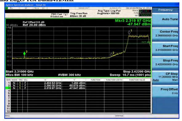
Band Edges Test Data 2462MHz
