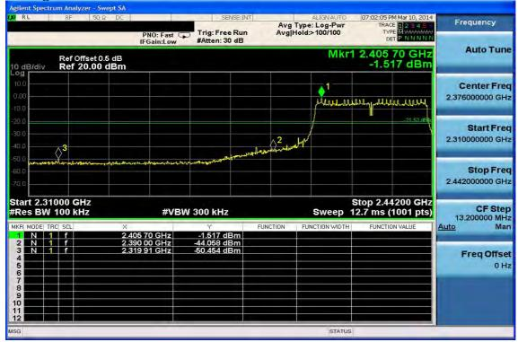
Band Edges Test Data 2452MHz
