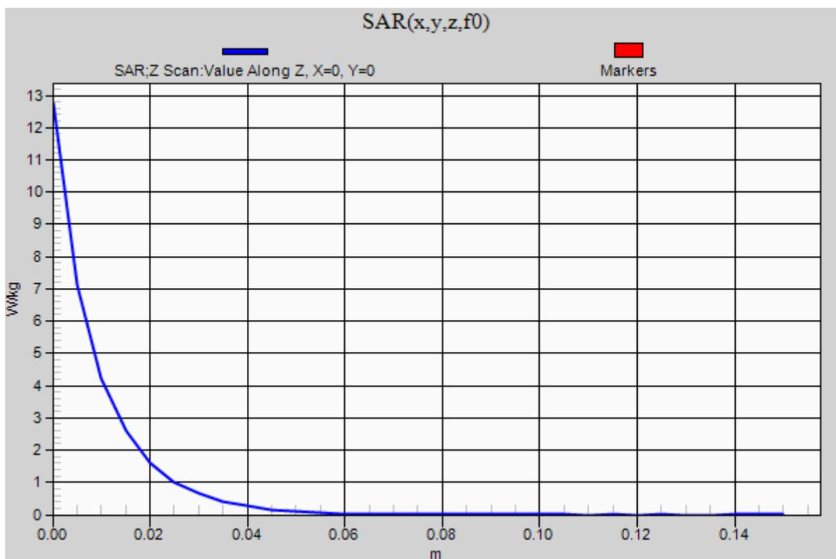
**20180425 Body 750MHz System Check Power 250mW**
