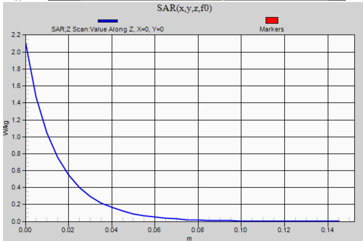
**20180426 Body 750MHz System Check Power 250mW**
