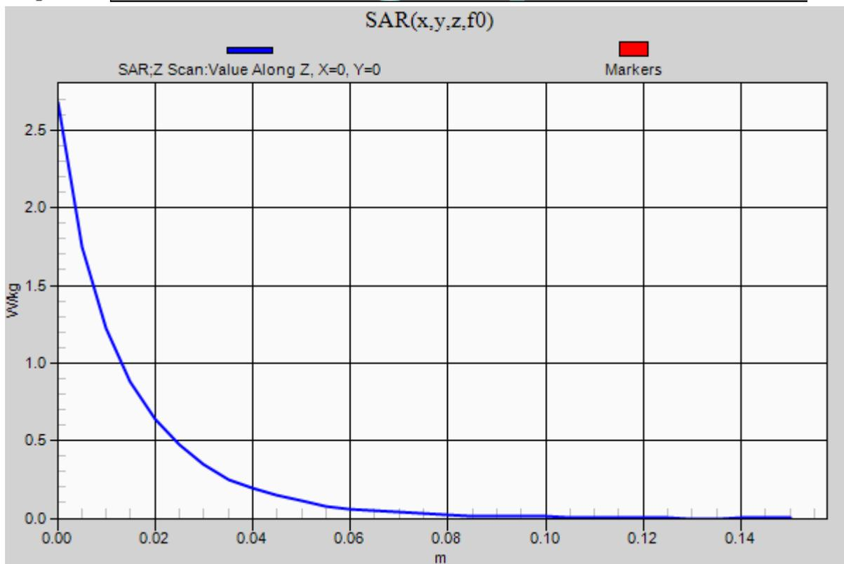
**20180427 Body 750MHz System Check Power 250mW**
