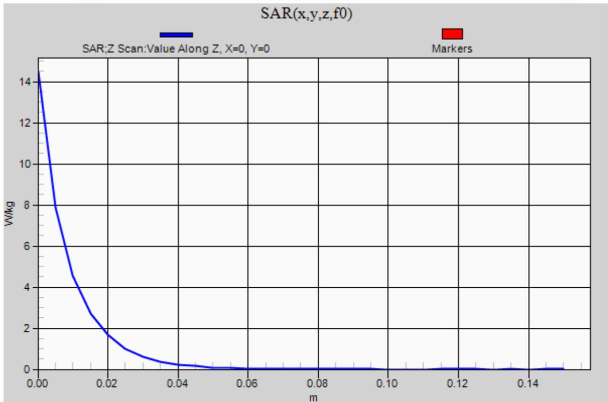
**20180419 Body 2600MHz System Check Power 250mW**
