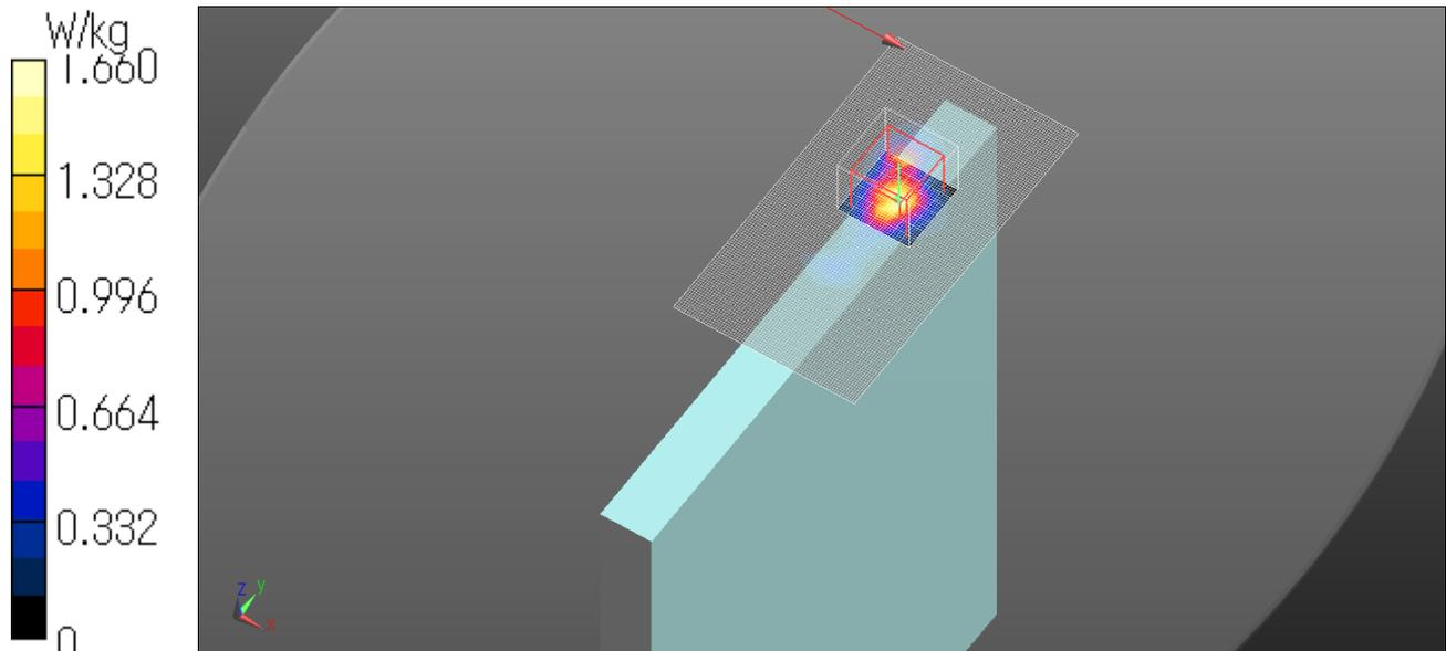
**WLAN 5.5G Aux Ant Edge3 11ac80 VHT0 0mm 5690MHz**
