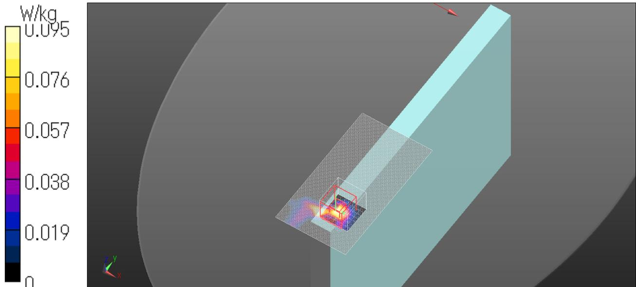
**WLAN 5.5G Aux Ant Rear 11ac80 VHT0 0mm 5690MHz**
