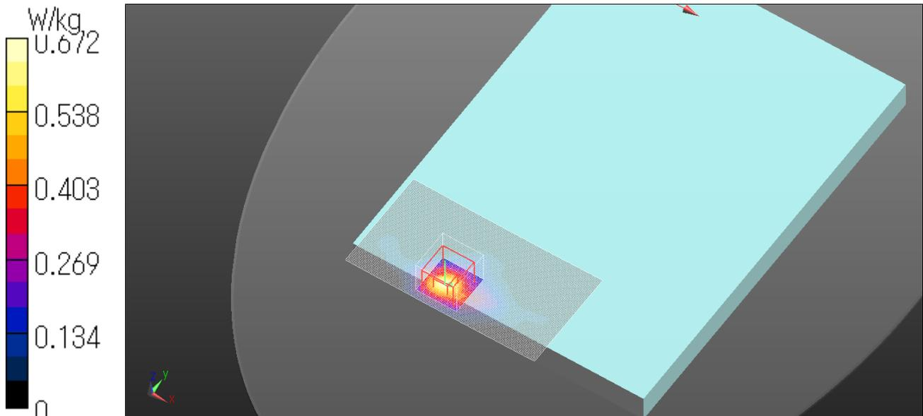
**WLAN 5.5G Aux Ant Edge1 11ac80 VHT0 0mm 5690MHz**
