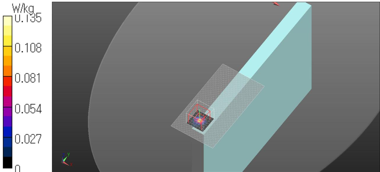
**WLAN 5.5G Main Ant Edge3 11ac80 VHT0 0mm 5690MHz**
