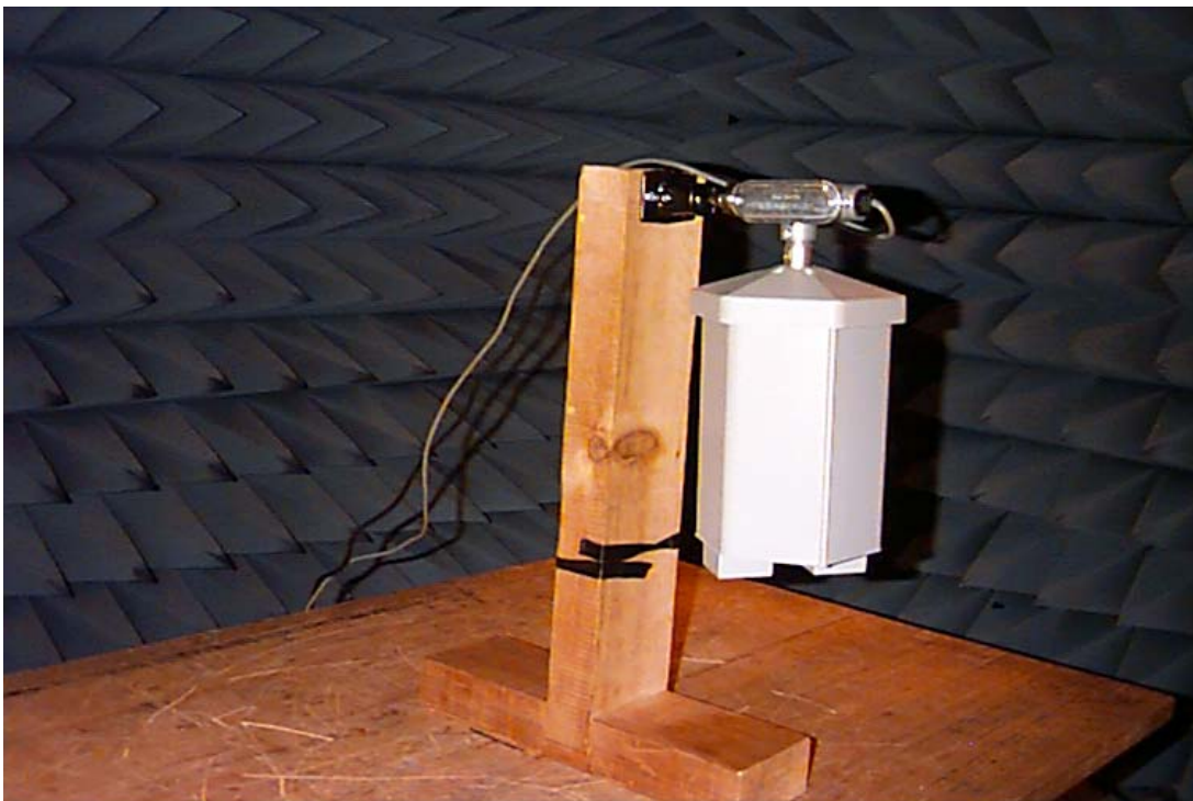
2.4GHz PIFA Antenna (integral), 0dBi
