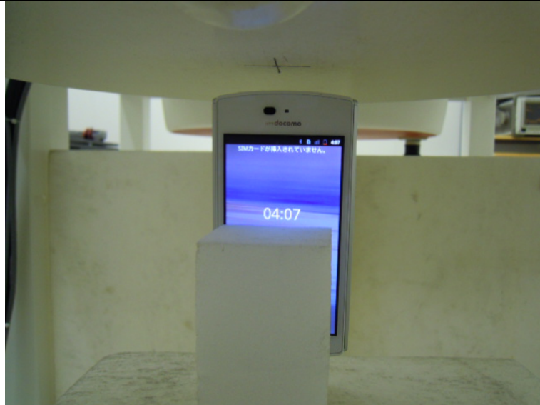
WLAN Body Top edge 10mm (Hotspot mode)
