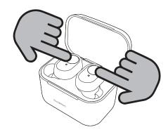
耳机在充电状态,红灯亮;同时连按左右耳机金属键3次,蓝灯闪3次,重置成功。
