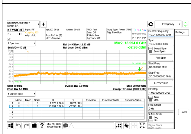
5G NR n25 10MHz BPSK Middle Channel RB1-1, ID:50822
