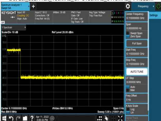
Det Lel_802.11ax_160MHz_CF 6185MHz_6110MHz_-71.6dBm
