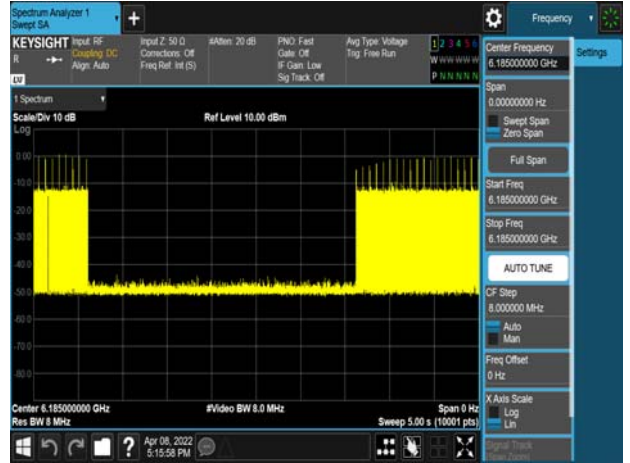
Det Le1_802.11ax_160MHz_CF 6185MHz_6185MHz_-66.6dBm
