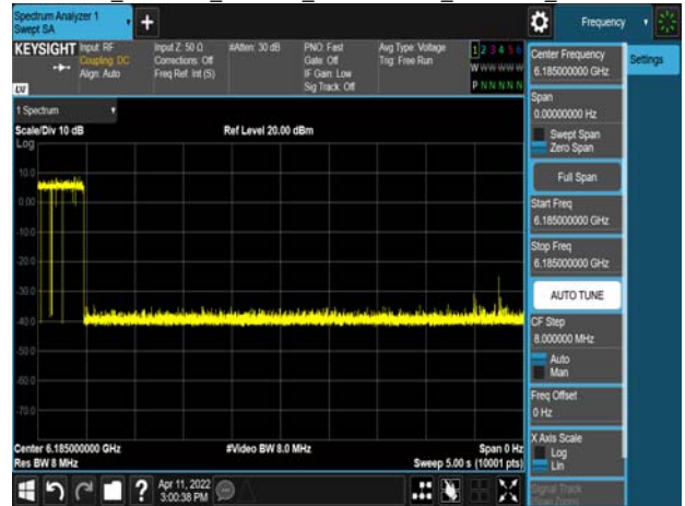
Det Lel_802.11ax_160MHz_CF 6185MHz_6185MHz_-71.6dBm
