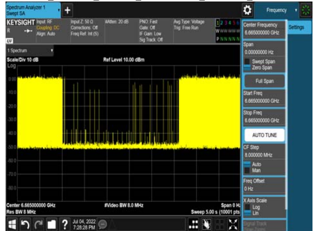
Det Le1_802.11ax_160MHz_CF 6665MHz_6665MHz_-69.06dBm
