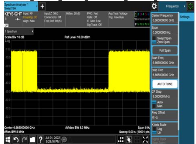
Det Le1_802.11ax_160MHz_CF 6665MHz_6665MHz_-69.06dBm
