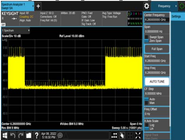
Det Le1_802.11ax_160MHz_CF 6185MHz_6260MHz_-72.6dBm
