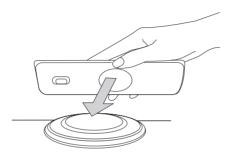
使用方法: 将手机无线接收感应区域对准E504产品 中心位置。此时E504会有一圈蓝灯亮起, 且手机显示正在充电状态。
