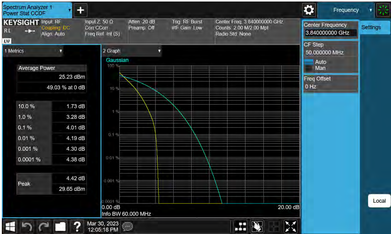
Sub6 n77. PAR Plot (60 M BW_Ch.656000_ BPSK)
