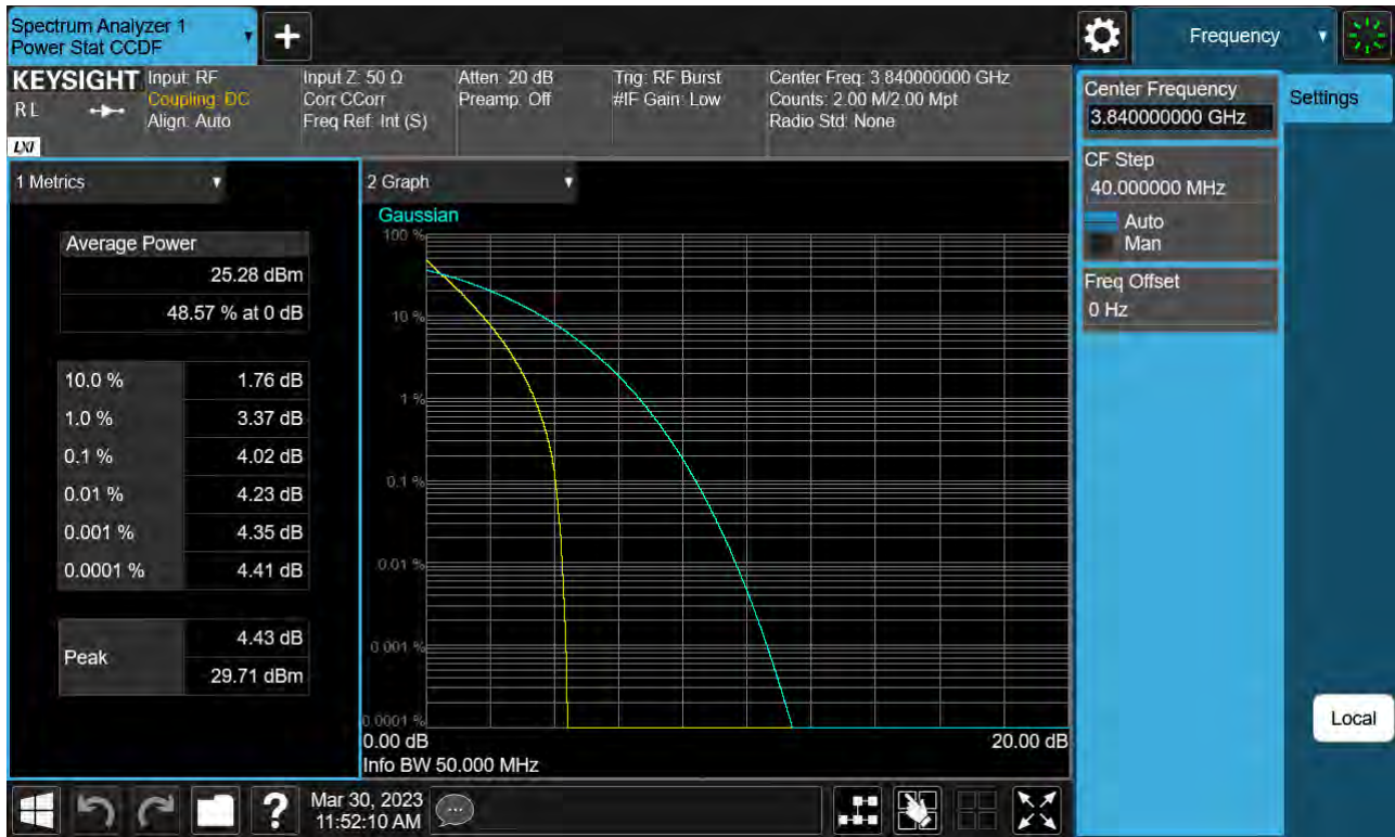
Sub6 n77. PAR Plot (50 M BW_Ch.656000_ BPSK)
