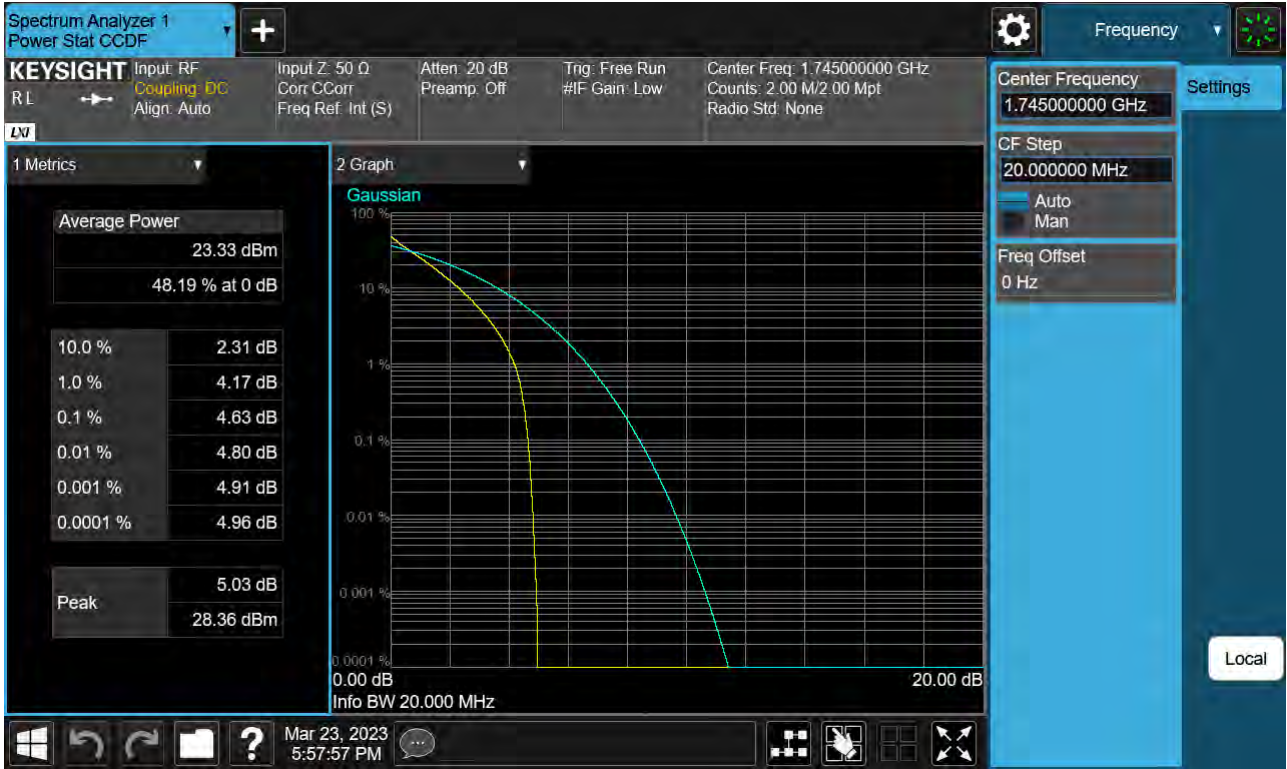
Sub6 n66. PAR Plot (20 M BW_Ch.349000_QPSK_Full RB)
