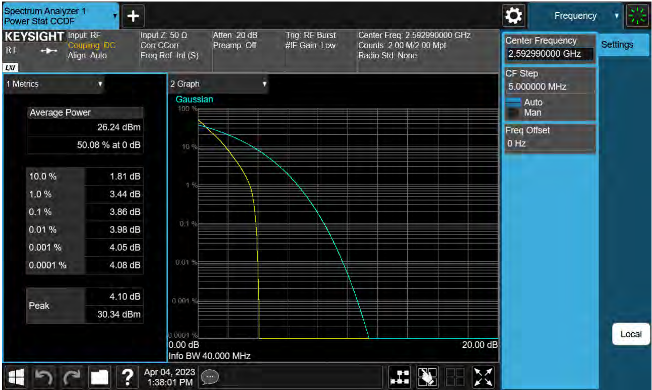
Sub6 n41. PAR Plot (40 M BW_Ch.518598_BPSK)
