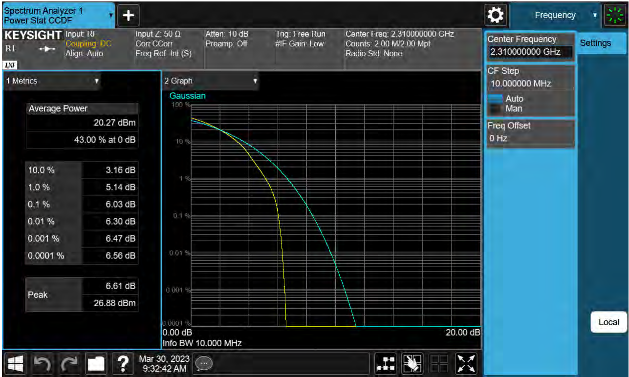
Sub6 n30. PAR Plot (10 M BW_Ch.462000_64QAM_RB50_0)
