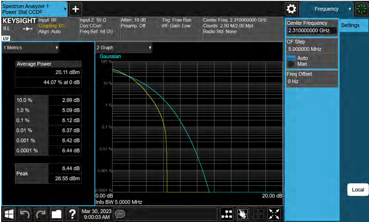
Sub6 n30. PAR Plot (5 M BW_Ch.462000_64QAM_RB25_0)
