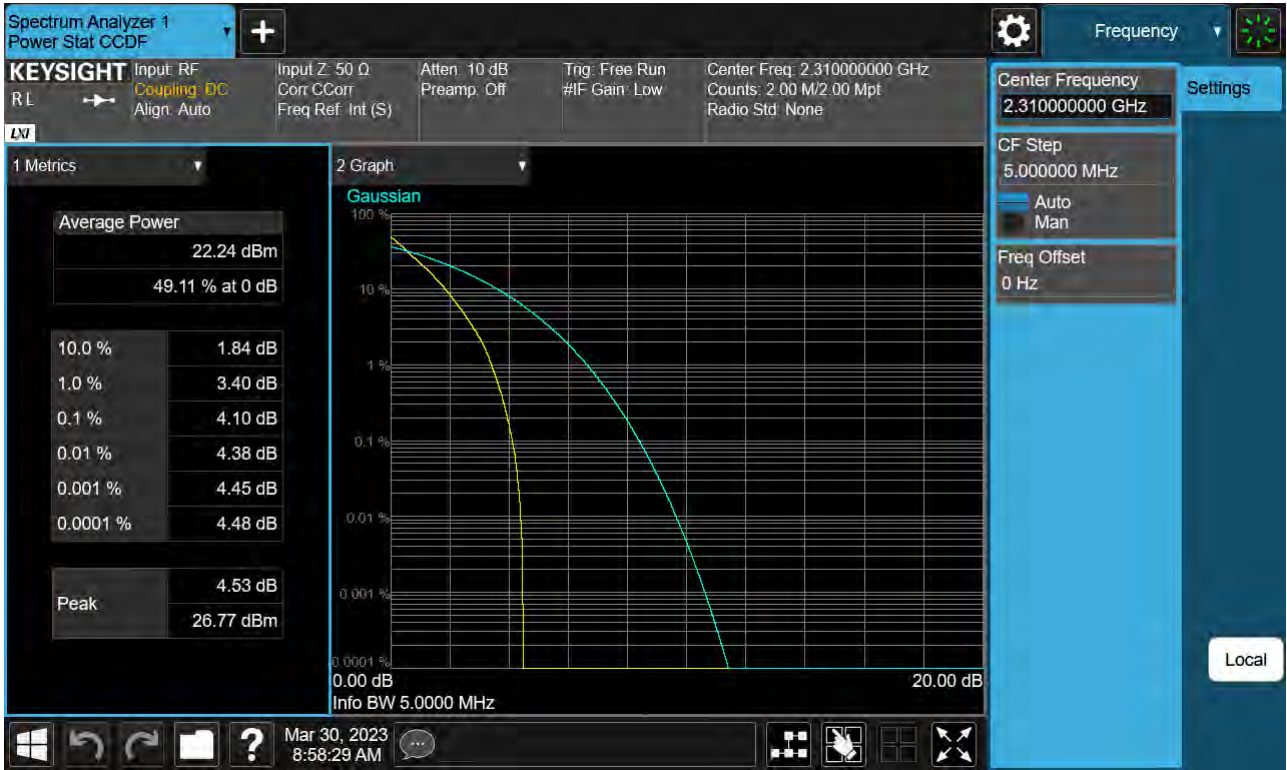
Sub6 n30. PAR Plot (5 M BW_Ch.462000_BPSK_RB25_0)
