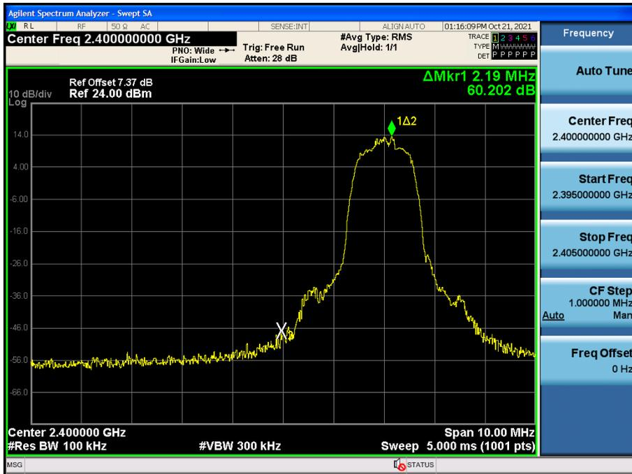
Test Plots without hopping ( $\pi/4$ DQPSK)
