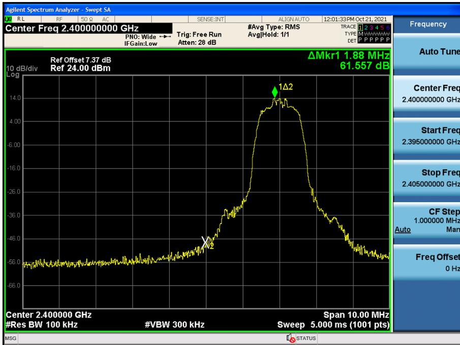
Test Plots without hopping ( $\pi/4$ DQPSK)
