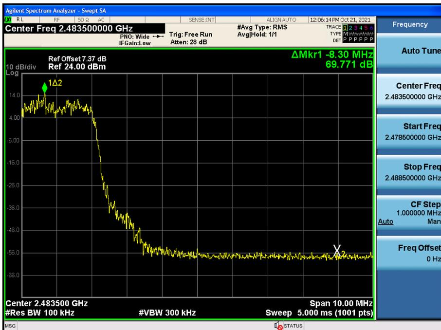
Test Plots with hopping ( $\pi/4$ DQPSK)
