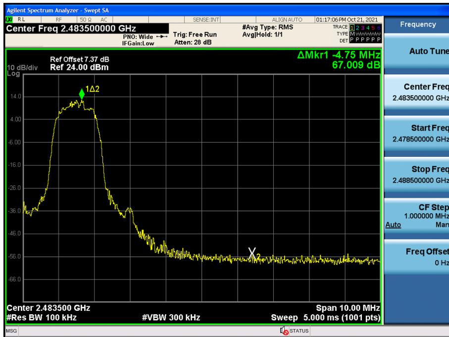
Test Plots without hopping ( $\pi/4$ DQPSK)
