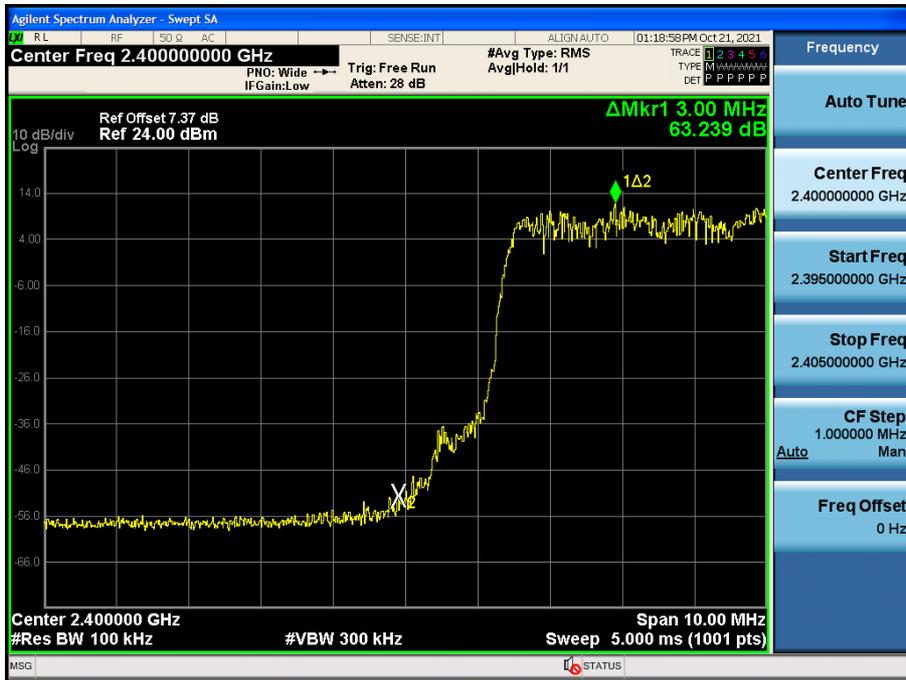
Test Plots with hopping ( $\pi/4$ DQPSK)
