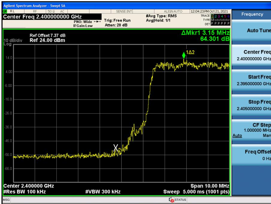
Test Plots with hopping ( $\pi/4$ DQPSK)
