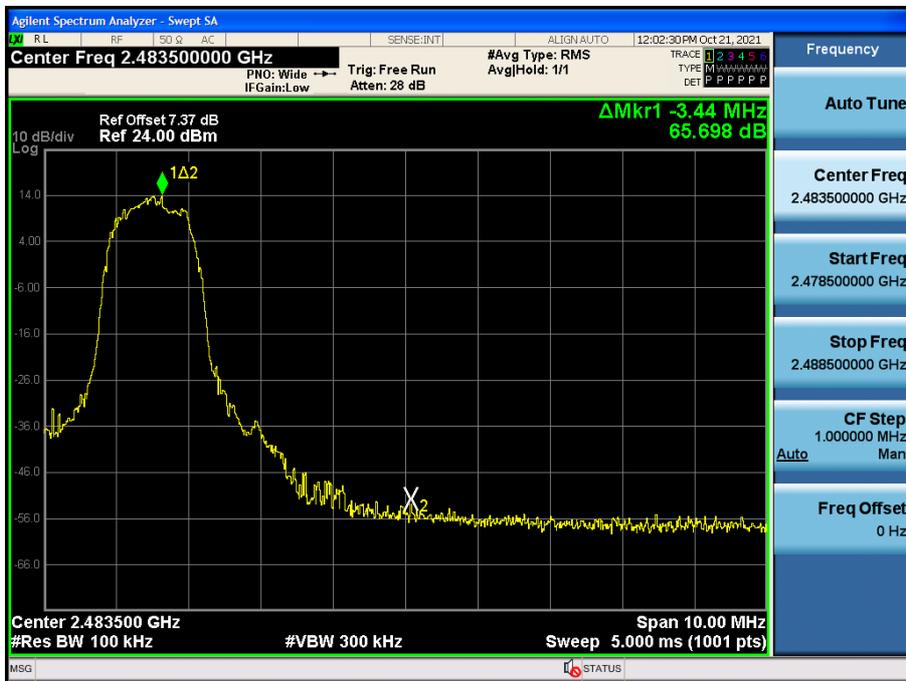
Test Plots without hopping ( $\pi/4$ DQPSK)
