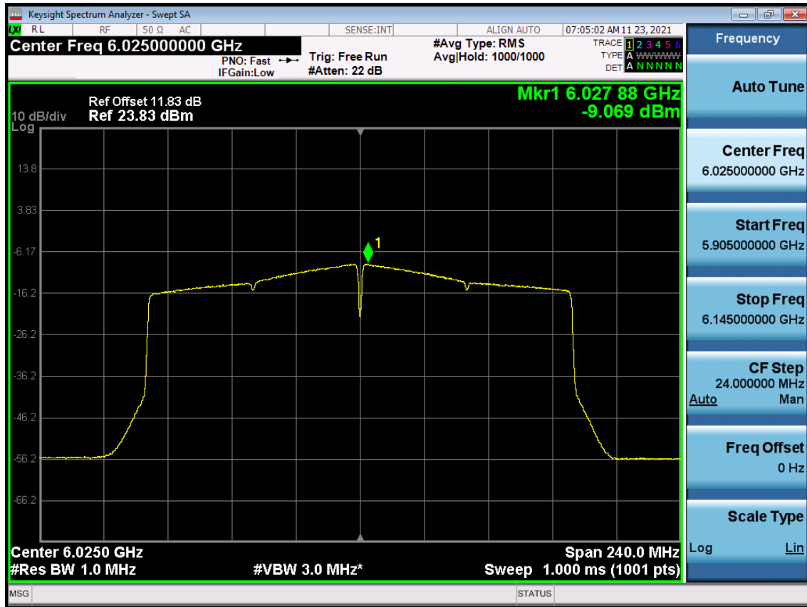
Bandwidth 160M 80_SU Ch.15(6025 MHz) SU
