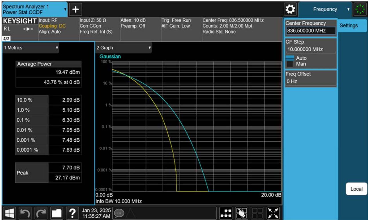
BAND 26. PAR Plot (10 M BW Ch.26915 256QAM_RB50_0)
