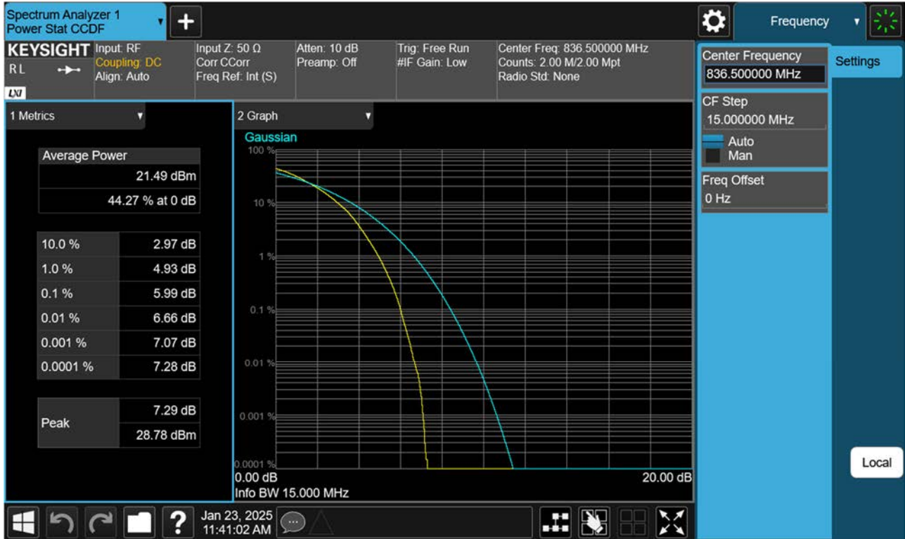
BAND 26. PAR Plot (15 M BW Ch.26915 64QAM RB 75_0)
