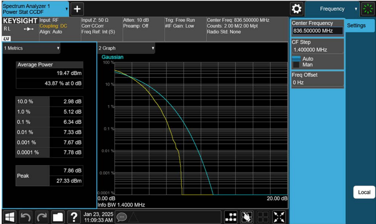
BAND 26. PAR Plot (1.4 M BW Ch.26915 256QAM_RB6_0)
