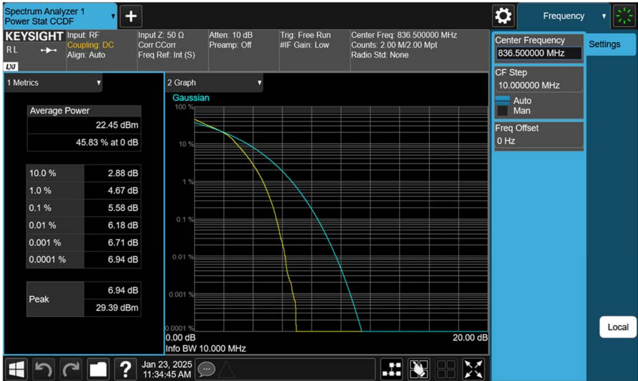
BAND 26. PAR Plot (10 M BW Ch.26915 16QAM_RB50_0)
