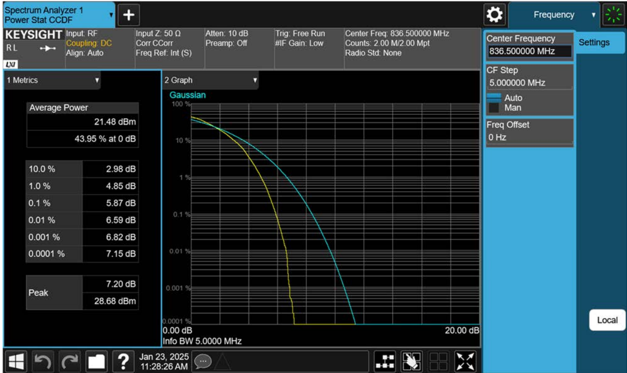
BAND 26. PAR Plot (5 M BW Ch.26915 64QAM_RB25_0)
