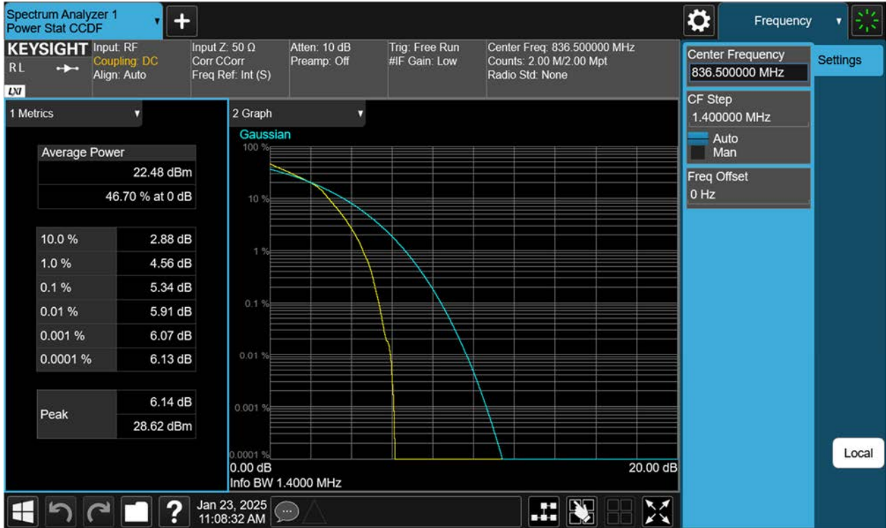
BAND 26. PAR Plot (1.4 M BW Ch.26915 16QAM_RB6_0)
