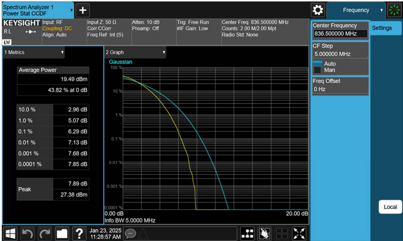
BAND 26. PAR Plot (5 M BW Ch.26915 256QAM_RB25_0)
