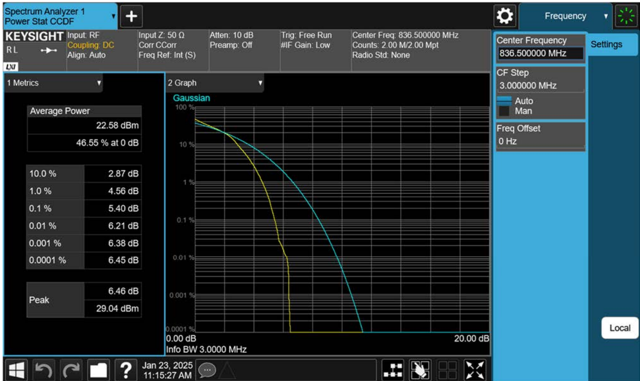
BAND 26. PAR Plot (3 M BW Ch.26915 16QAM_RB15_0)
