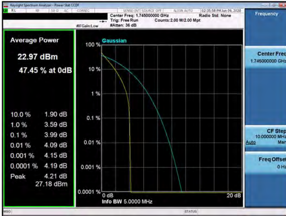
Plot 7-625. PAR Plot (n66 - 5.0MHz DFT-s-OFDM BPSK - Full RB Configuration)
