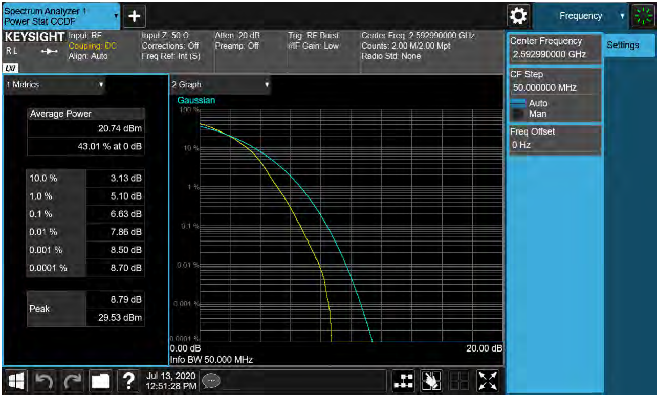
Sub6 n41. PAR Plot (50M BW_Ch.518598_64QAM_RB25_0)
