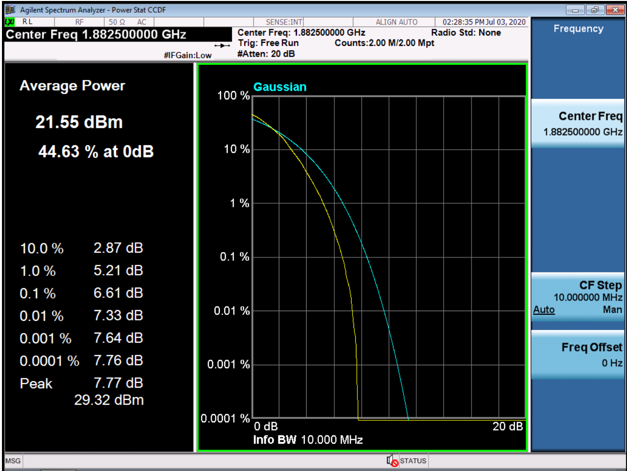
Sub6 n25(2). PAR Plot (10M BW Ch.376500 64QAM RB 50_0)
