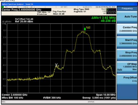
Test Plots without hopping ( $\pi/4DQPSK$ )
