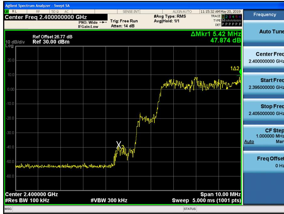
Test Plots with hopping ( $\pi/4$ DQPSK)
