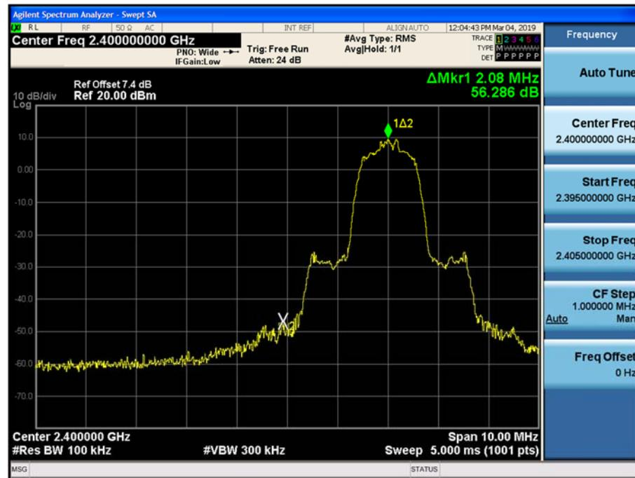
Test Plots without hopping ( $\pi/4$ DQPSK)
