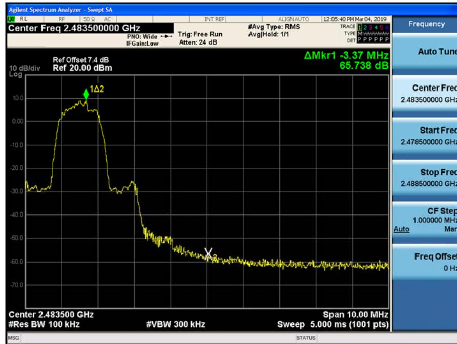
Test Plots without hopping ( $\pi/4$ DQPSK)
