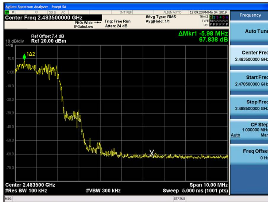
Test Plots with hopping ( $\pi/4$ DQPSK)
