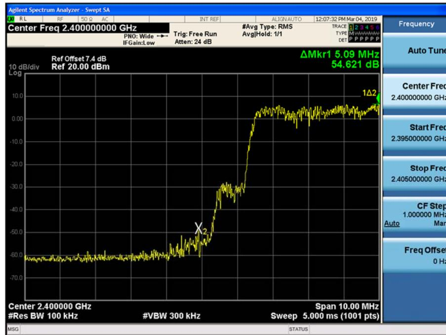
Test Plots with hopping ( $\pi/4$ DQPSK)
