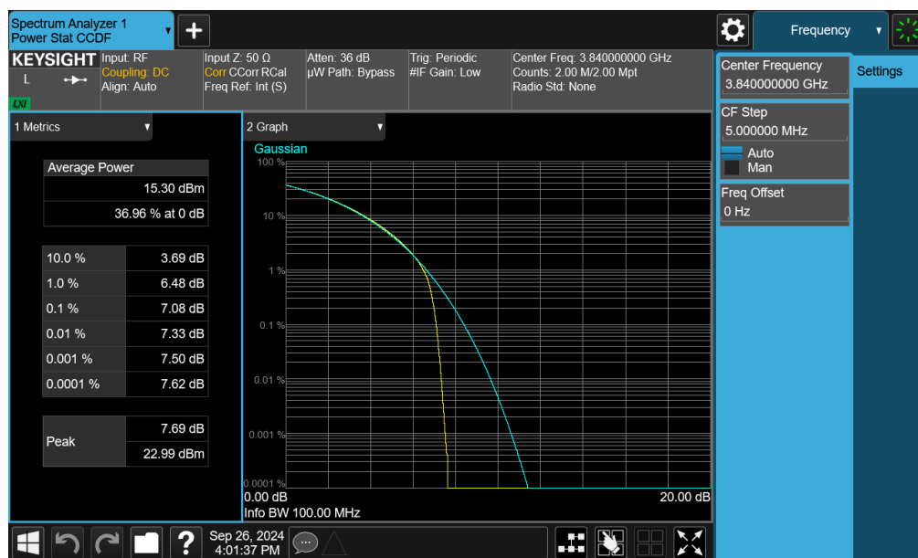
Plot 7-161. PAR Plot (NR Band n77 - 100MHz CP-OFDM-QPSK – Full RB - Ant D)
