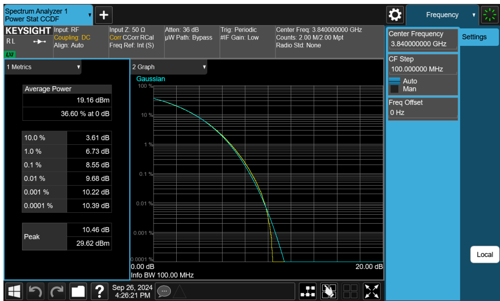
Plot 7-156. PAR Plot (NR Band n77 - 100MHz CP-OFDM-256QAM - Full RB - Ant I)
