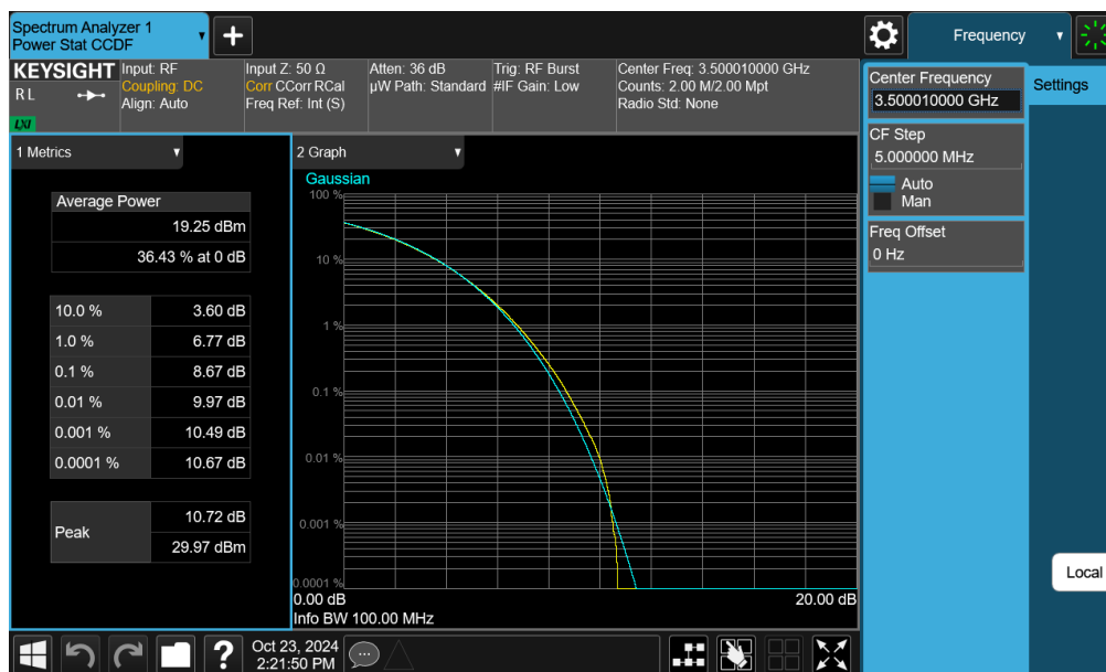
Plot 7-141. PAR Plot (NR Band n77 - 100MHz CP-OFDM-256QAM – Full RB - Ant F)
