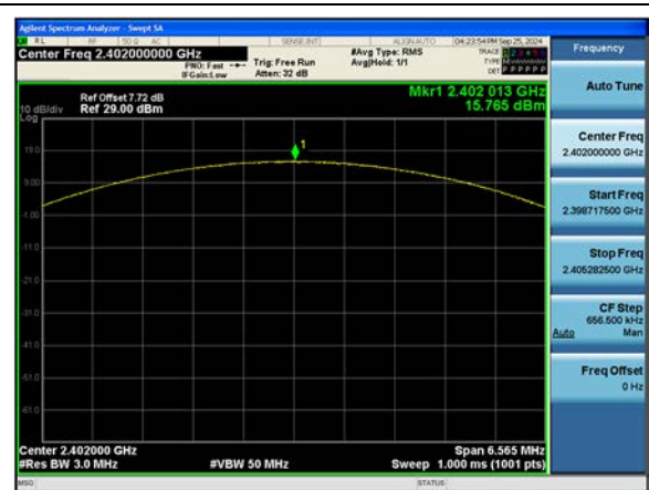
ANT.2 \pi/4 DQPSK : Peak Power (Ch. 39)
