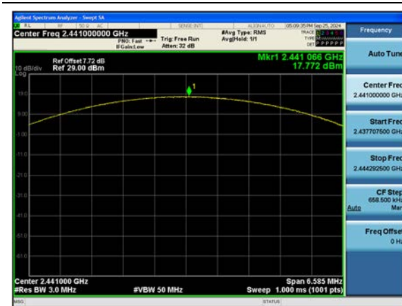
ANT.1 \pi/4 DQPSK : Peak Power (Ch. 39)
