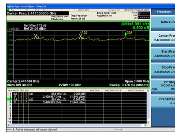
ANT. 1 \pi/4 DQPSK : Channel Separation
