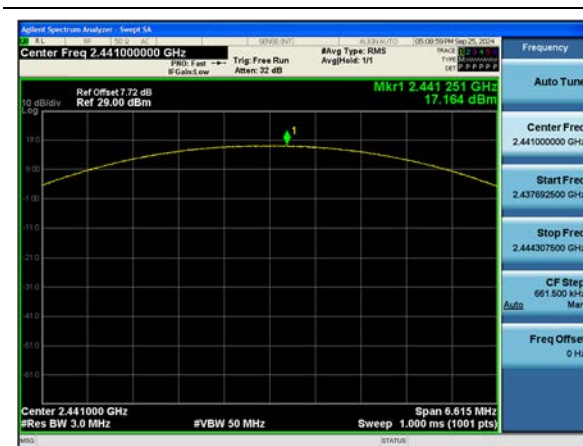
ANT.1 \pi/4 DQPSK : Peak Power (Ch. 39)
