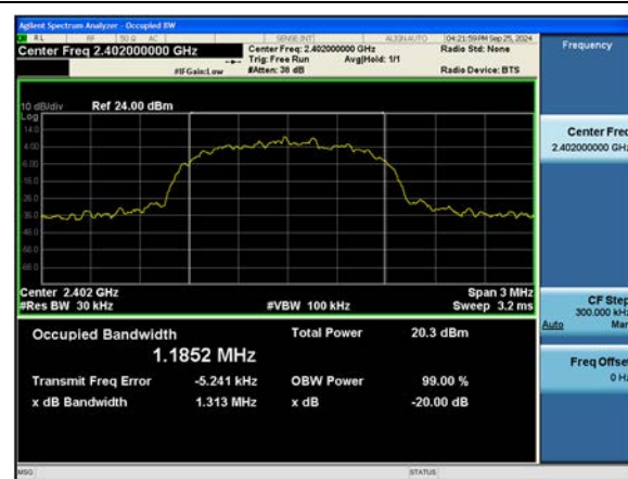
ANT. 2 \pi/4 DQPSK 20 dB BW & 99% OBW (Ch. 78)
