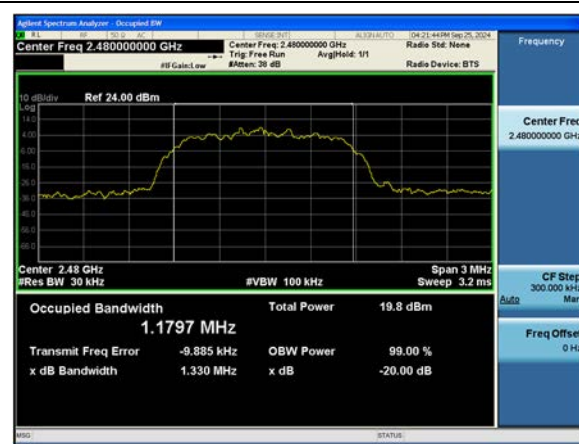
ANT. 2 \pi/4 DQPSK 20 dB BW & 99% OBW (Ch. 78)
