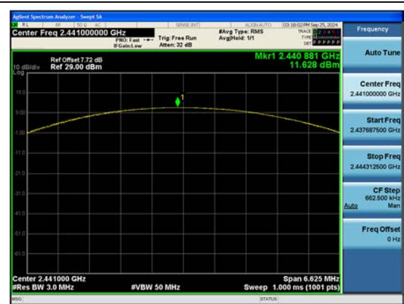
Dual ANT.2 \pi /4DQPSK : Peak Power (Ch. 39)
