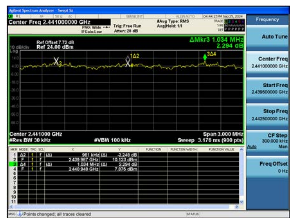
ANT. 2 \pi/4 DQPSK : Channel Separation
