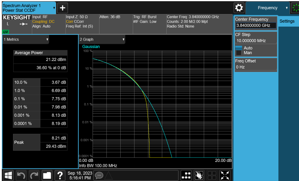
Plot 7-112. PAR Plot (NR Band n77 - 100MHz CP-OFDM QPSK - Full RB - Ant1)
