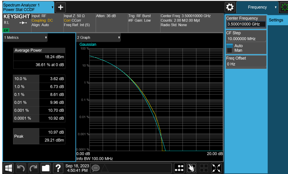
Plot 7-116. PAR Plot (NR Band n77 (DoD) - 100MHz CP-OFDM 256-QAM - Full RB - Ant1)
