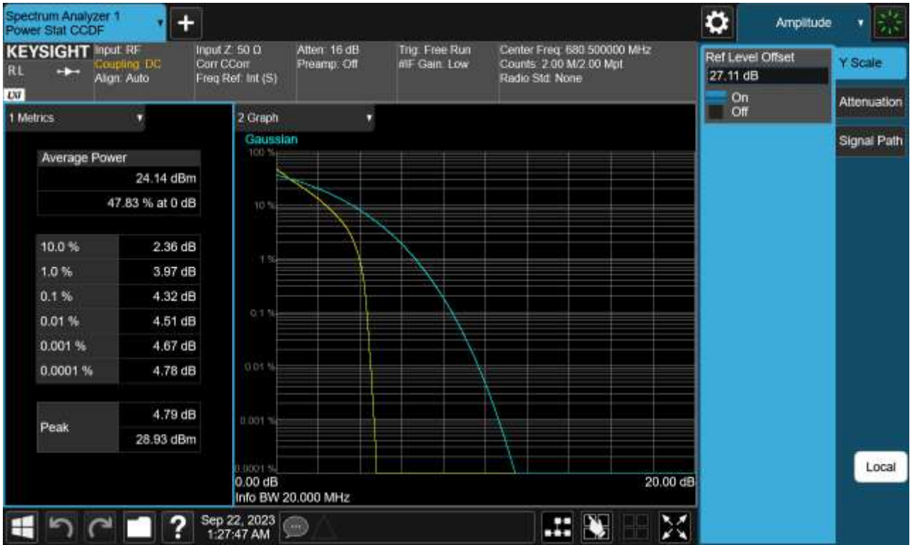
Sub6 n71. PAR Plot (20 M BW_Ch.349000_QPSK_Full RB)
